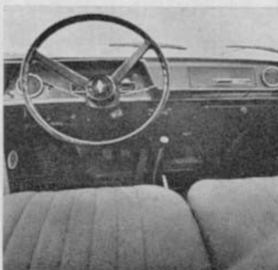
Renault Major från förarsplatsen: I stort är förarsplatsen bra utformad, men handbromsen sitter absolut för långt ner på golvet. De båda runda hälen på instrumentbrädan är friskluftintag.
